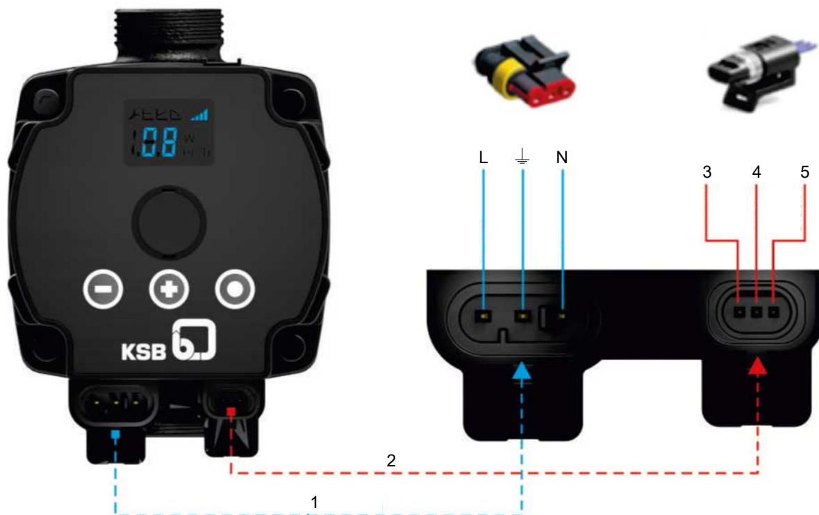
Abb. 9: Elektrische Anschlussleitung und Steuerleitung anschließen
